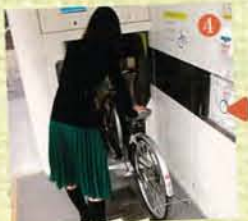
扉が開くので自転車をセッティングすると自動的に自転車が格納されます
